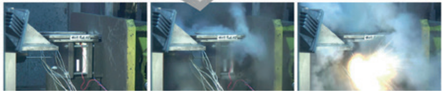
BILD 3 Zellmodul mit Batteriehitzeschild (1) und Swelling-Kompensationsblech (2) – Explosionsartige Befehuerung bei Kurzschluss einer geladenen Zelle (© Dana)
